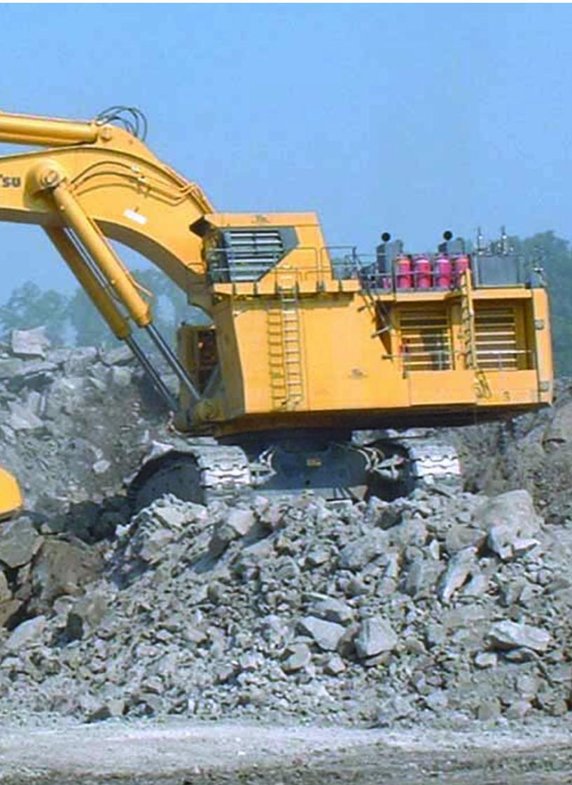
Рассчитан на работу с карьерными самосвалами грузоподъемностью 136 - 317,5 тонн (150 - 320 тонн США)
